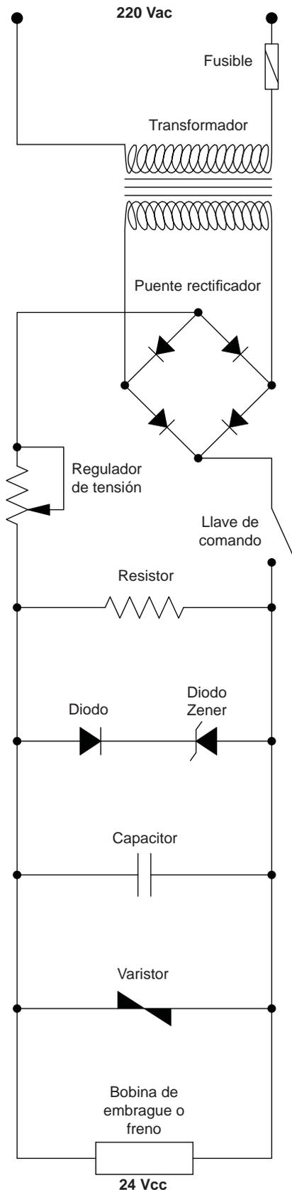
Los embragues y frenos monodisco fabricados por Tekmatic S.A. funcionan con corriente continua. Frecuentemente esta corriente continua se toma de un rectificador conectado en derivación. La tensión continua necesaria para la bobina es casi siempre considerablemente mas baja que la tensión alterna disponible. Por eso se requiere adicionalmente un transformador.
