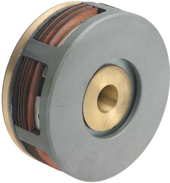
Los embragues electromagnéticos multidisco regulables con anillo colector se presentan en dos versiones de disco exterior. TIPO F con ferodo para trabajar en seco y TIPO S con bronce sinterizado para trabajar con lubricación o en seco.
