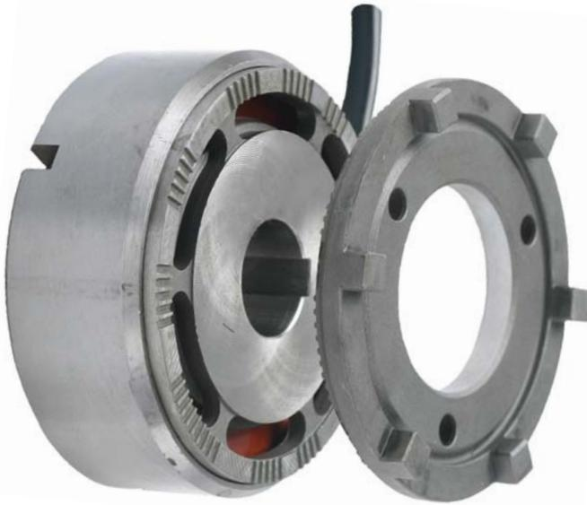
El portabobina es estático, y va retenido con las ranuras talladas para tal fin. Tenga presente que la finalidad de las ranuras no es soportar el torque transmitido por las placas dentadas sino solamente el arrastre de los rodamientos. Por eso se debe permitir un pequeño juego entre la ranura y la chaveta para evitar cargar axial o radialmente los rodamientos.
