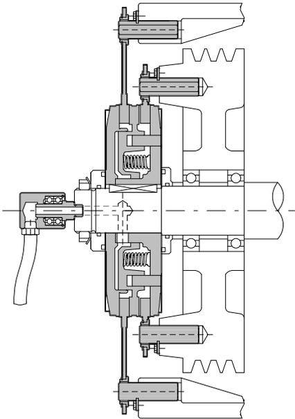
Conjunto embrague freno a comando neumático línea EFN, con ala larga de freno y corta para el embrague, en una aplicación típica de balancines, prensas, etc. El volante contra el cojinete del cuerpo y el embrague en voladizo. Este montaje facilita mucho las tareas de mantenimiento del conjunto embrague freno.
