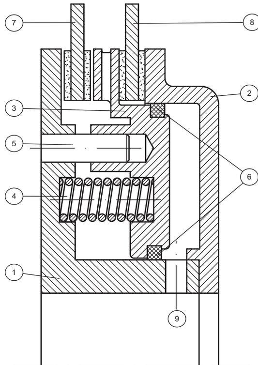
reducción del torque y aumentará el tiempo de inserción. En caso de contaminarse proceder a la inmediata limpieza o reemplazo del material de fricción.
