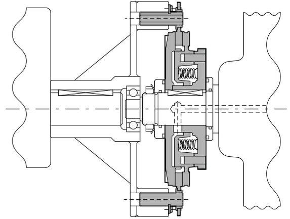
Freno neumático línea FN, con ala corta, aplicado como embrague. En el momento que se aplica aire se desvincula la transmisión y el eje conducido queda liberado. Esta aplicación es indicada en casos donde la transmisión es continua y sólo se desea cortarla en raras ocasiones.
