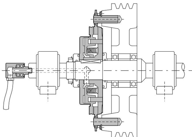
Embrague neumático línea EN montado entre soportes para movimiento del eje conducido. El movimiento entra por la polea volante. La alimentación se hace a través del eje.
