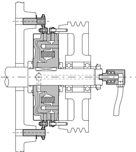
Conjunto embrague freno línea LN, con ala de freno corta y de embrague con bujes. Especialmente recomendada en casos donde los entrecentros de fijación de los discos de embrague y freno deben ser reducidos.
