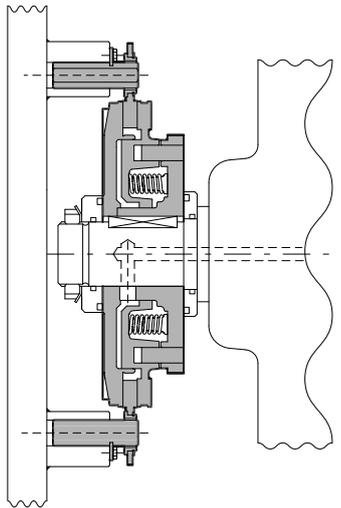
Freno neumático línea FN, con ala corta, de acción por resortes. Está normalmente frenado, y cuando es alimentado libera el eje permitiendo así su rotación.
