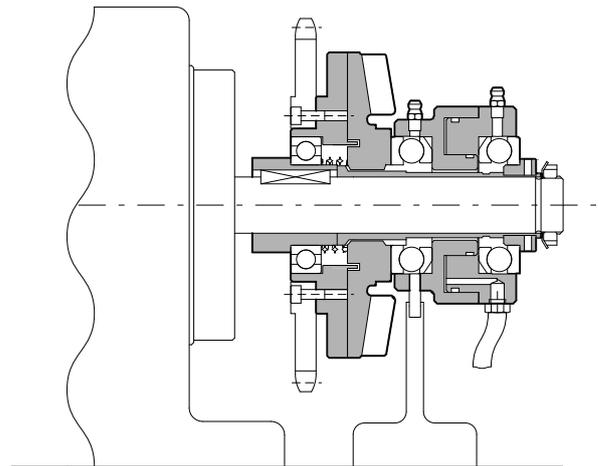
Embrague neumático línea EOFN acoplado el mando de un motor a un piñón de cadena. Para su funcionamiento no es necesario agujerear el eje, y no necesita junta rotativa por tenerla ya incorporada. El cuerpo se enchaveta al eje y el pistón se retiene mediante la leva provista a pedido para tal fin.
