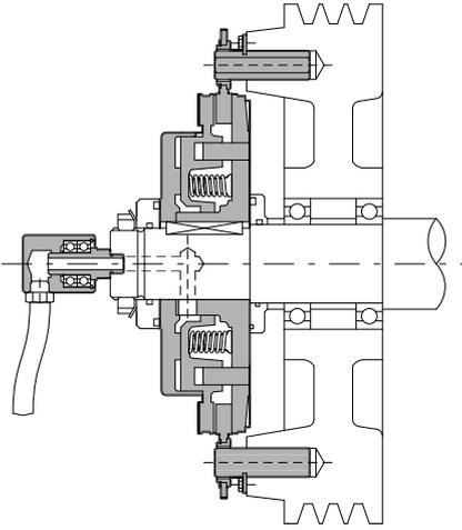
Embrague neumático línea EN, con ala corta, montado en el extremo del eje con su junta rotativa. El volante gira permanentemente, y al aplicar aire transmite el movimiento por el eje. En el momento que se quita el suministro de aire, el eje queda liberado pero no frenado.
