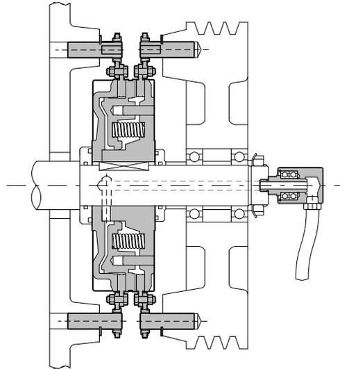
Conjunto embrague freno a comando neumático línea LN, con discos de embrague y freno con alas cortas, montado entre el cuerpo y el volante, con alimentación de aire a través del eje. Esta disposición sirve para múltiples aplicaciones.
